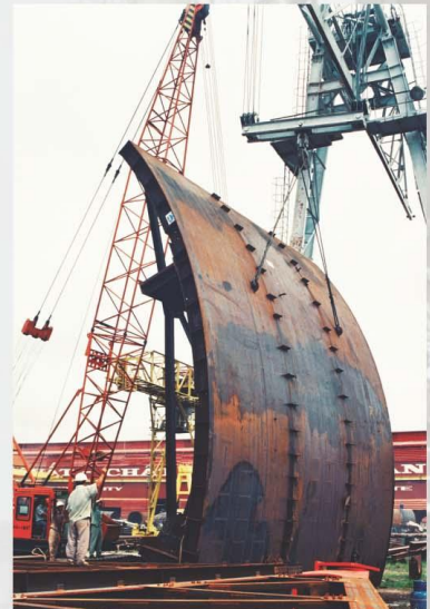
Chế tạo thiết bị van công cho nhà máy thủy điện Hàm Thuận Fabrication of gate valve for Ham Thuan Hydro Power Plant.
