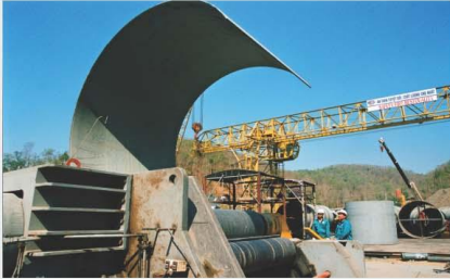
Máy lóc tôn dày 100 mm 100mm Rolling machine
