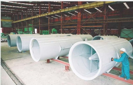
Chế tạo quạt thông gió hầm đường bộ đèo Hải Vân. Fabrication of ventilation fans for Hai Van Pass tunnel.
