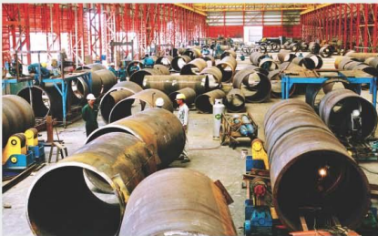
Chế tạo ống cọc nhồi cho mỏ dầu Rạng Đông. Fabrication of steel pile for Rang Dong oil-field.
